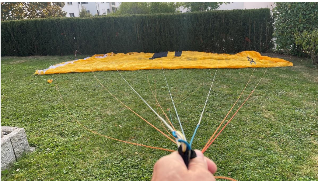
Abbildung 3: ...mit allen Leinen wurde bei oder nach der Kollision gewaltsam abgerissen.
