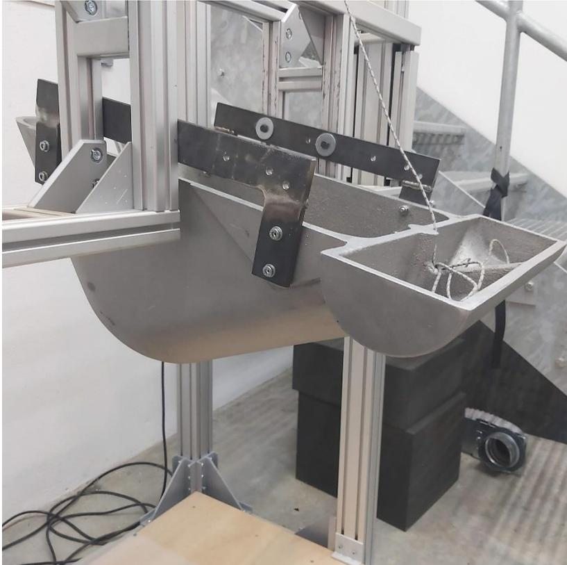
Bild 3: Dummy in 75° nach hinten abgekippter Position, DHV-interner Test (Aufprall Rücken)
