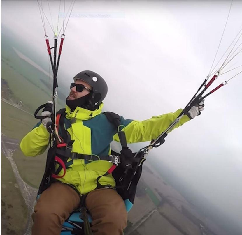
Abbildung 2: Lösen der Außenbremse beim Kurvenflug
