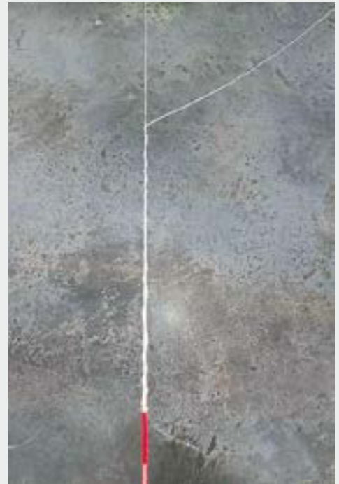
↑ Diese zig-fach verdrillte Steuerleine kann eine Verkürzung des Steuerweges bewirken
