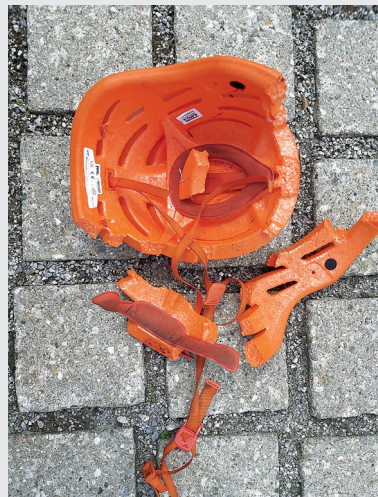
↑ Dieser Kletter-Helm wurde bei einem Gleitschirmunfall durch Aufprall auf einen Felsen zerstört. Der Pilot erlitt tödlich Kopfverletzungen.
