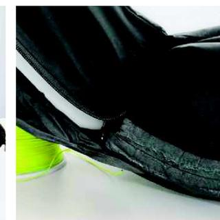
Protectordetail: Nur unter der Sitzfläche ist der „echte“ Protector mit dem in einer Stoffhülle eingewebten und in Kammern unterteilten Schaumstoffkern und einer separaten Schicht härteren Schaumstoff. Im Rückenbereich schließt sich eine 12 cm starke Lage einfachen Schaumstoffs an
