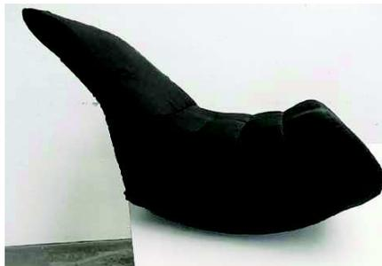
Protektor: Schaumprotektor mit 14 cm Stärke nur unter der Sitzfläche, oberhalb dünner Schaumstoff. Messwert laut Prüfstelle EAPR: 48,3 G. Im Bereich des oberen Rückens zusätzlich Kunststoffplatte als Durchdringungsschutz
