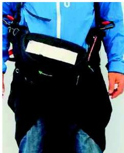
Zusätzliche Herausfallsicherung bei unverschlossenen Gurten: kein Front-Cockpit und Beinsack können bei offenen Gurten verschlossen werden.
