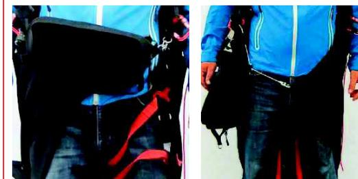
Zusätzliche Herausfallsicherung bei unverschlossenen Gurten: ja, zusätzlich gut sichtbare, rot gefärbte Beingurte
