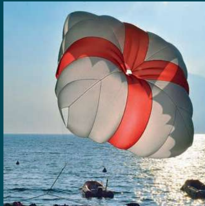
↑ Die Kreuzkappe X-One weist nicht nur die typischen Luftauslassschlitze in ihren Ecken auf, sondern auch noch ein zentrales Ausblasloch. Die Flanken sind weit heruntergezogen. Das erhöht die Pendelstabilität.
