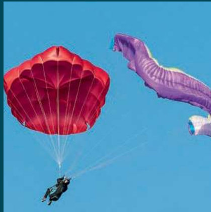
↑ Der Pentagon-Retter besitzt fünf Ecken. Diese Form, bei der nie zwei Seiten genau parallel zueinander liegen, soll Pendelbewegungen gut dämpfen.
