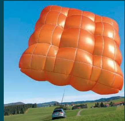
↑ Die Evocross gehört zu jener Art von Kreuzkappen am Markt, die eine bewusst eingebaute Vorwärtsfahrt aufweisen. Das Gleiten in eine Richtung reduziert das Pendeln.
