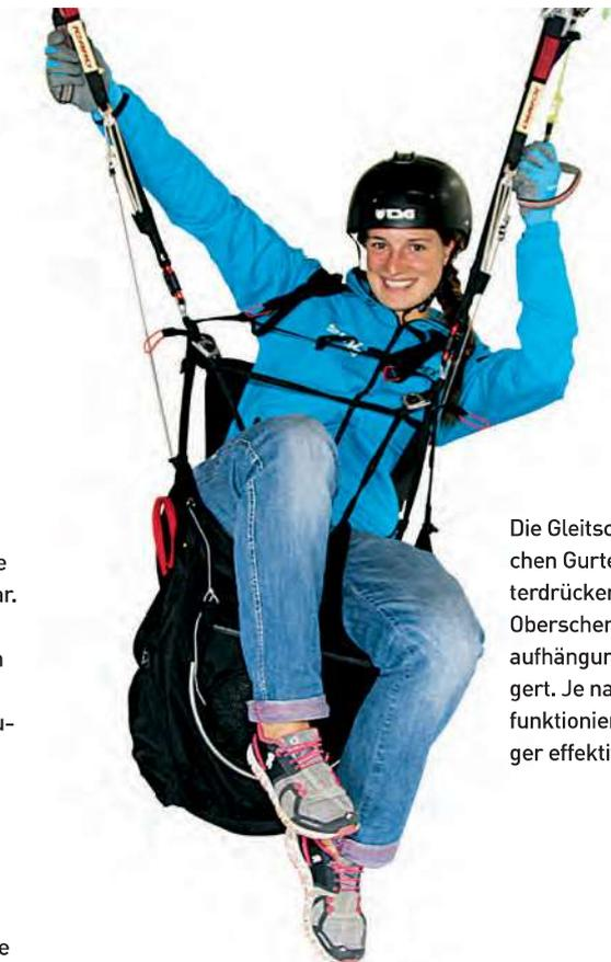
Die Gleitschirmsteuerung mit solchen Gurten erfolgt durch Hinunterdrücken und Heben der Oberschenkel. So wird die Hauptaufhängung verkürzt und verlängert. Je nach Gurtkonstruktion funktioniert dies mehr oder weniger effektiv.
