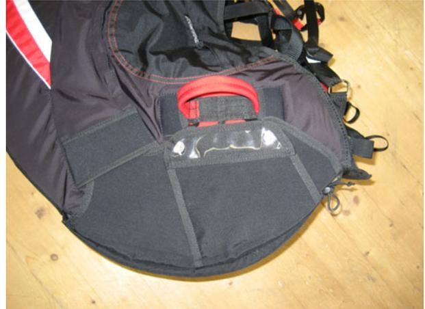
6. Packschnüre entfernen und anschließend kontrollieren, dass der Container korrekt verschlossen ist.
