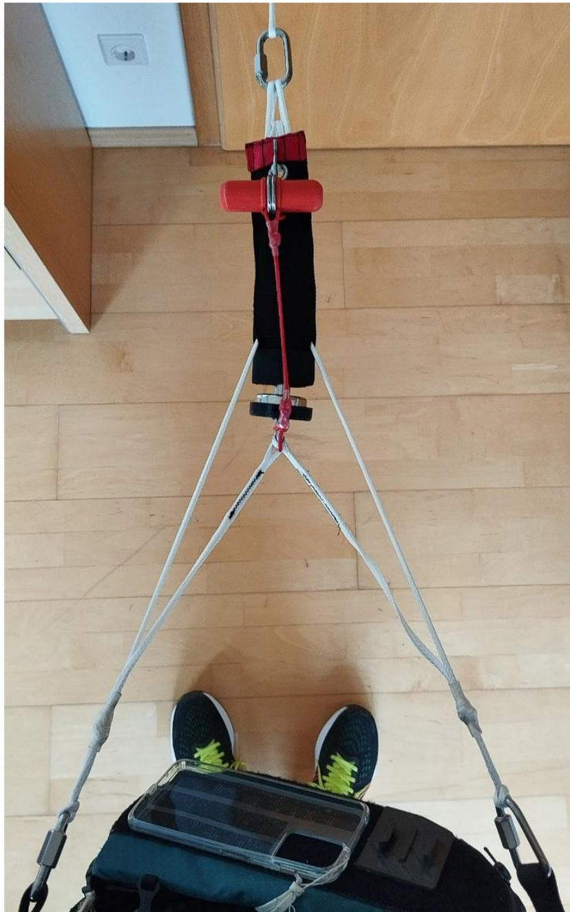
Abbildung: Klinke am Gurtzeug montiert und mit freilaufenden Leinen und korrekt am Schleppseil, bzw. Schraubglied eingehängt.
