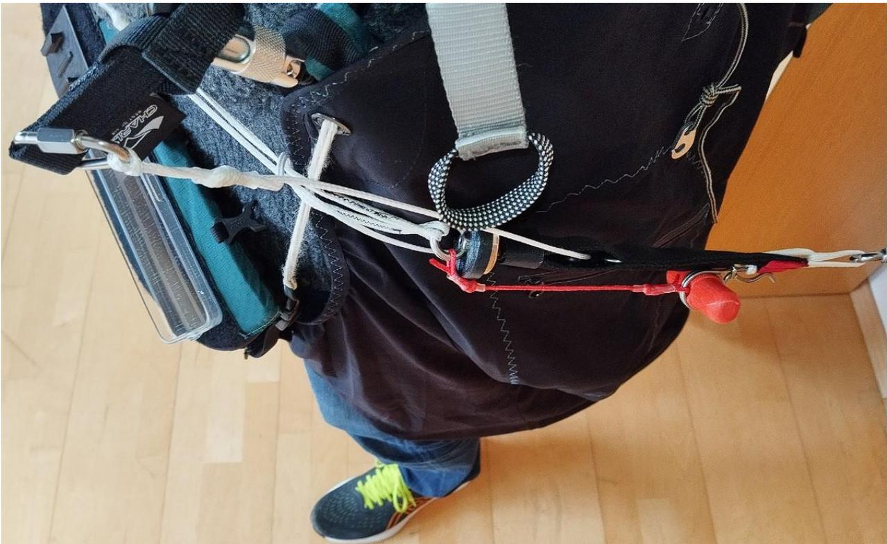
Abbildung: Das Schleppseil geht beim Wegfliegen von der Winde auf Hüfthöhe am Piloten vorbei.
